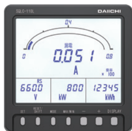
漏電電流計測画面
