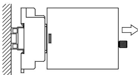
＜注意＞ トランスデューサ本体を斜めに抜き差しすると本体の端子が曲がり、ソケットとの接触不良などの障害の原因となります。
