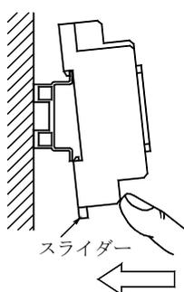
ソケット底面のスライダーを下側にして、爪をレールに引っ掛けてから、ソケット下部を図の矢印方向に押し込んで固定してください。
