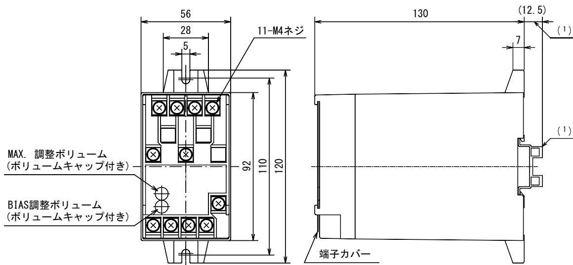
注(1) IEC/DIN レール (高さ 15mm) 取付けの場合です。(レールは 35mm 幅をご使用ください。)
