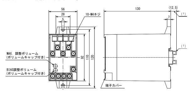
注(1) IEC/DIN レール (高さ 15mm) 取付けの場合です。(レールは 35mm 幅をご使用ください。) 端子カバーは標準添付です。
