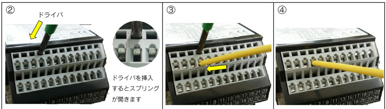
【ドライバ及び電線挿入口】
