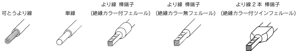
可とうより線の場合、芯線のバラけに十分注意してください。バラけ防止として棒端子があります。推奨の棒端子形名は下記をご参照ください。また、棒端子の圧着には専用の圧着工具をご使用ください。
