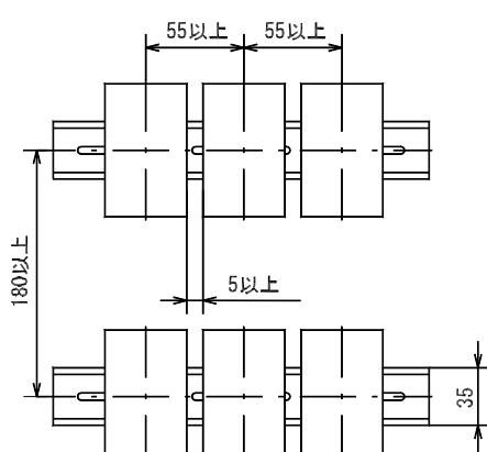
レールはIEC、DIN規格の35mm幅レール（強化型）をご使用ください。
